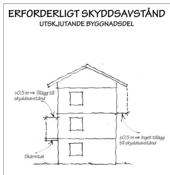
Figur 8.4. Tillägg till erforderligt skyddsavstånd vid utskjutande byggnadsdel.
