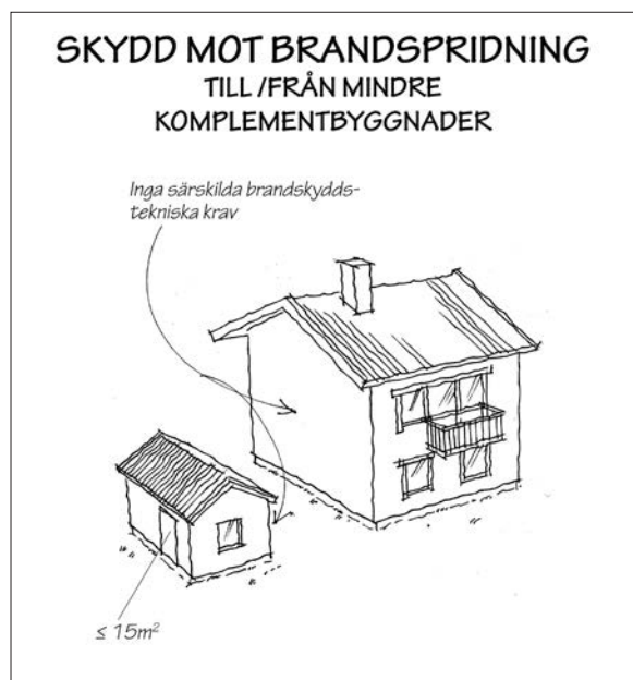
Figur 8.2. BBR 5:61 ställer inga krav på att särskilda åtgärder behöver vidtas för att förhindra brandspridning till och från komplementbyggnader som har en byggnadsarea på högst 15 m 2 .
