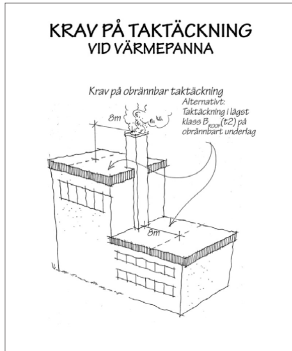
Figur 8.15. Krav på taktäckning invid skorsten ansluten till en värmepanna avsedd för förbränning av fasta bränslen.
