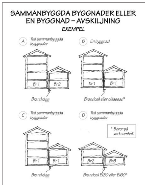
Figur 8.5. Brandskyddsteknisk avskiljning mellan sammanbyggda byggnader.
